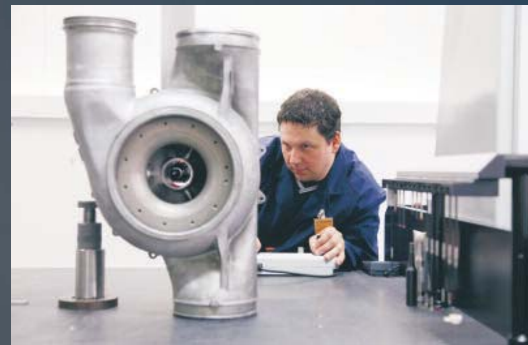
Mit einer neuen 3D-Koordination-Meßmaschine vermisst Martin Rosenkranz das Turbinengehäuse von einer Boeing 747-Klimaanlage.
