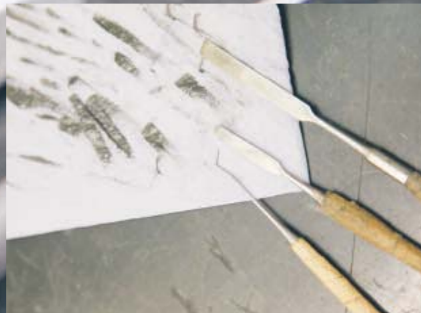
Spatel verschiedener Größe und Form sind bei Lufthansa Technik Intercoat ein viel verwendetes Arbeitsmittel.
